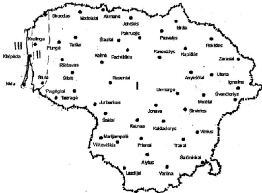
2 pav. Lietuvos vėjo apkrovos rajonai I – v_{ref,0} = 24 m/s, II – v_{ref,0} = 28 m/s, III – v_{ref,0} = 32 m/s. /
