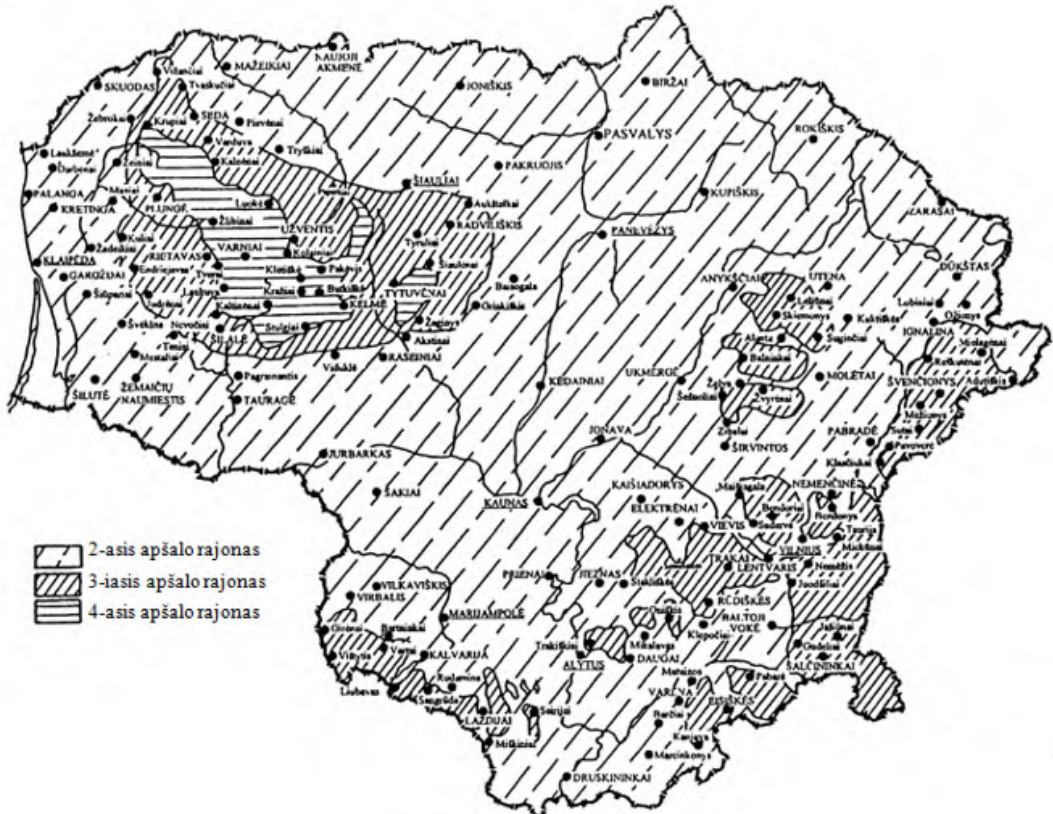
4 pav. Lietuvos Respublikos teritorijos rajonavimo pagal elektros tinklo apkrovas nuo apšalo žemėlapis
